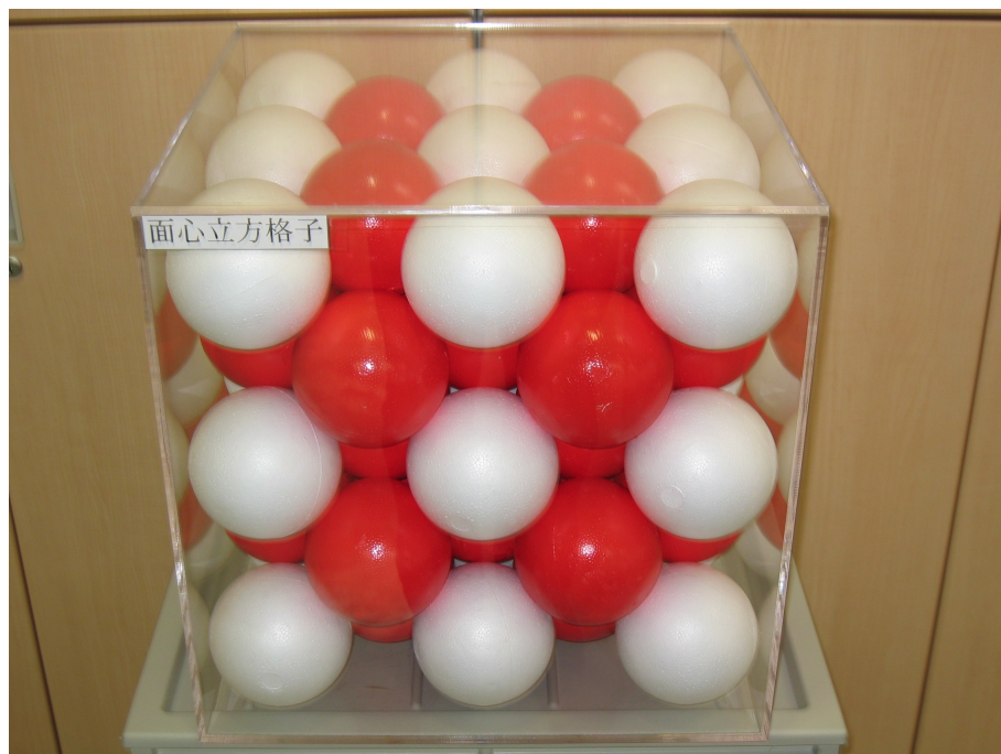
面心立方格子の点に球の中心を配置する玉詰
