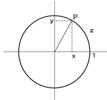
図 2: 半径 1 の円周上の点  $P = (x, y)$  を考える．円弧  $1P$  の長さ  $z$  は積分  $z = \int_1^P \sqrt{dx^2 + dy^2} = \int_1^x \frac{|dx|}{\sqrt{1-x^2}}$  で与えられる．すると  $z$  と  $x$  の関係は， $x = \cos(z)$  で与えられる．
