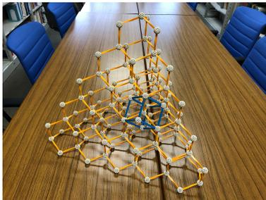
図 18: ダイヤモンド結晶格子模型
