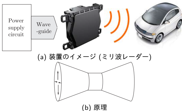
図 4.24: 導波管ハイパスフィルタ
